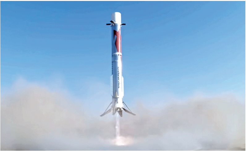
8月19日,视频截图显示朱雀三号遥二运载火箭一级级在着陆过程中展开着陆支腿,正在着陆。 新华社发(蓝箭航天 供图)
